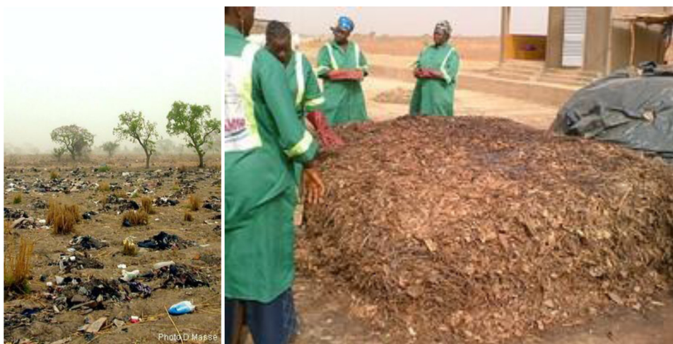
Fig. 3. D'une gestion non durable à une exploitation responsable des déchets municipaux. À gauche, des déchets bruts sans prétraitement épanchés sur un champ de céréales à proximité de Ouagadougou. À droite, une activité de compostage des déchets urbains sur le centre d'enfouissement technique de la ville de Ouagadougou.
