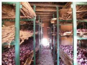
Le magasin est construit en semi dur avec toiture en terre et bois de rônier. Le magasin d'une surface minimale de 12,6 X 6,3 mètres carrés est capable de contenir plus de 12 à 20 tonnes d'oignons.
